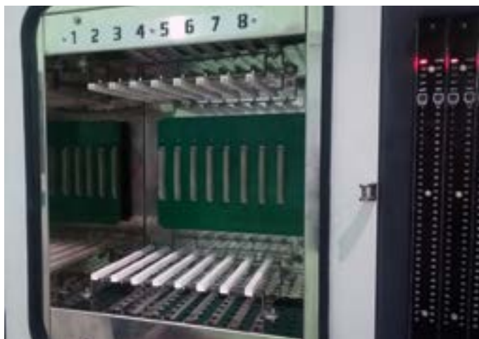
Рис. 6. Стенд термотренировки с вертикальным исполнением на основе тестовой и материнской печатных плат
