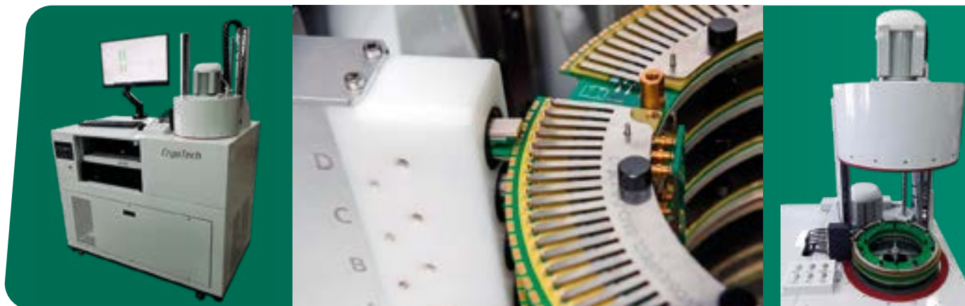
Рис. 7. Решение на основе механической коммутации ВЧ-сигнала
