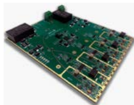
Рис. 8. Плата усилителей контактной головки – активный щуп
